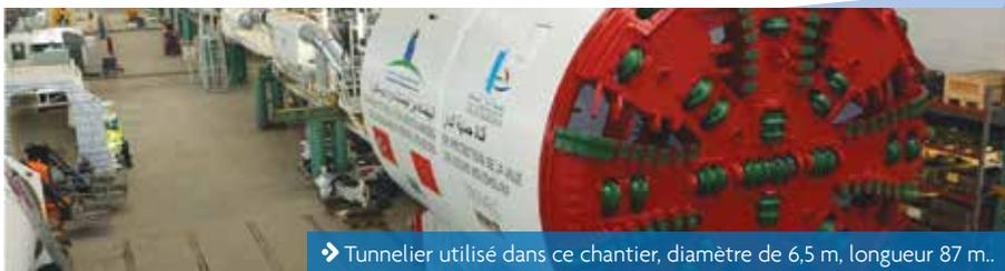
Les travaux d'excavation du tunnel ont commencé en juin 2015. La technique de creusement qui a été adoptée est celle du TBM (Tunnel Boring Machine) et voussoirs préfabriqués en béton armé.
